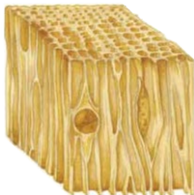
FIGURE 1 • Structure anatomique d'un bois
