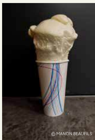
APERÇU DE LA MOUSSE DE POLYURÉTHANE INTÉGRANT LA CELLULOSE
